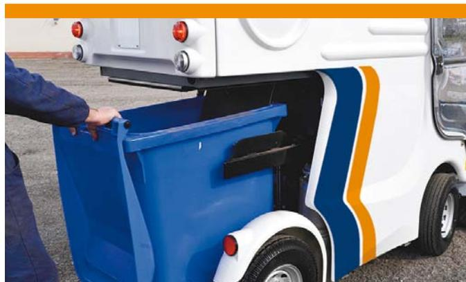
L'elevata potenza di aspirazione, unitamente al sistema filtrante che trattiene polveri fino a PM10, consente una ottimale azione di spazzamento su qualsiasi superficie anche senza l'ausilio di acqua.
